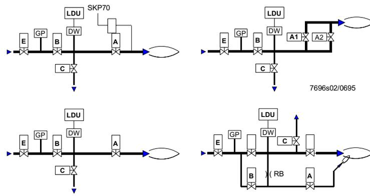
**Примеры соединений без трубы сброса в атмосферу (для практического применения, не учитываемого стандартом EN 676) при применении автоматов горения типа LFE..., LFL... или LGK..., или блока управления LEC...**
