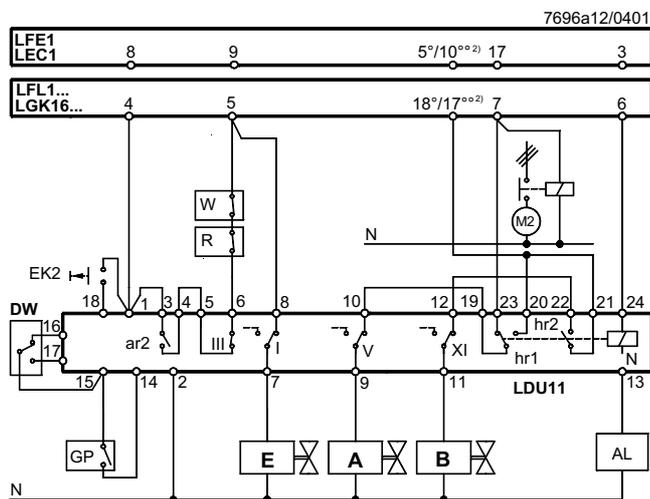
**Тест проверки клапана с 2 реле давления**
