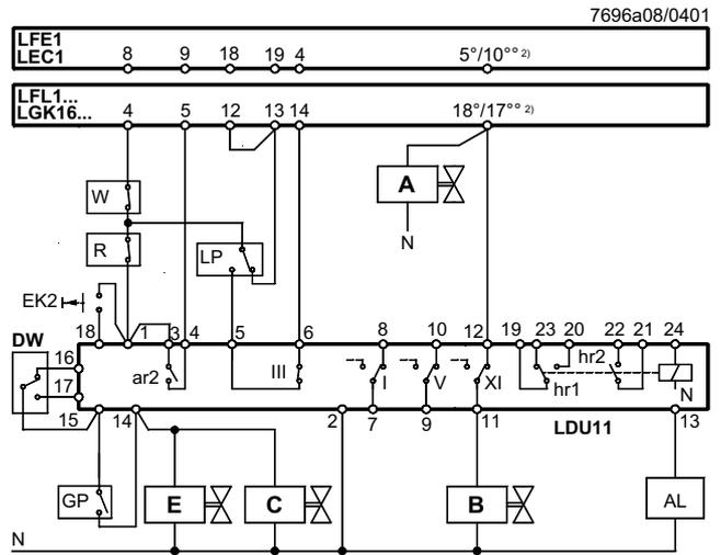
Тест проверки клапана с 2 реле давления
