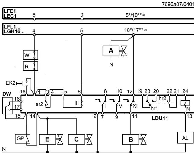
Тест проверки клапана в течение времени предпусковой (мин. 60 секунд)
