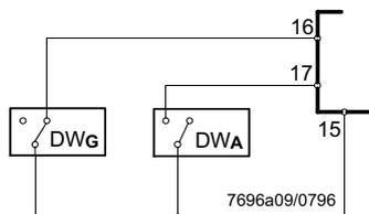
Давление воздуха «PL» для SKP70... должно быть достаточно высоким для открывания SKP70... несмотря на то, что закрыта воздушная заслонка горелки. В противном случае LDU11... инициирует блокировку при выполнении «Test1».
