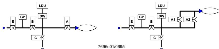
**Примеры соединений с трубой сброса в атмосферу при использовании автоматов горения типа LFE..., LFL... или LGK..., или блока управления LEC...**
