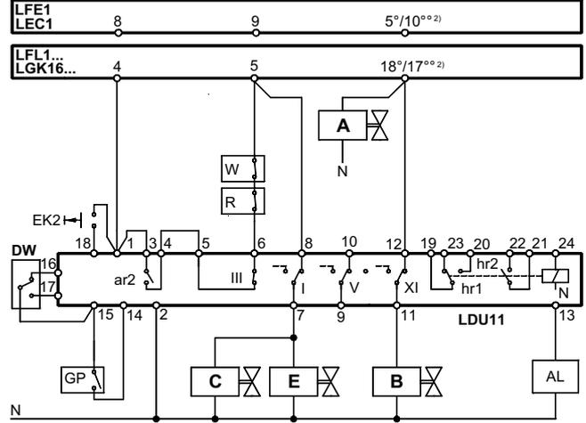
**Примеры соединений с трубой сброса в атмосферу при использовании автоматов горения типа LFE..., LFL... или LGK..., или блока управления LEC...**
