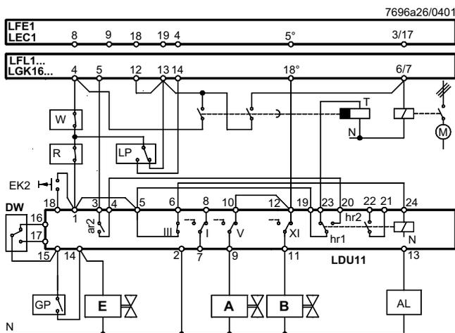
Тест проверки клапана в течение времени предподдувки (мин. 60 с)
