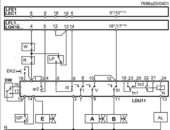
Тест проверки клапана с 2 реле давления
