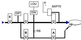
**Примеры соединений без трубы сброса в атмосферу при применении автоматов горения типа LFE..., LFL... или LGK..., или блока управления LEC... и исполнительного механизма SKP70... с горелками с регулируемым пламенем**
