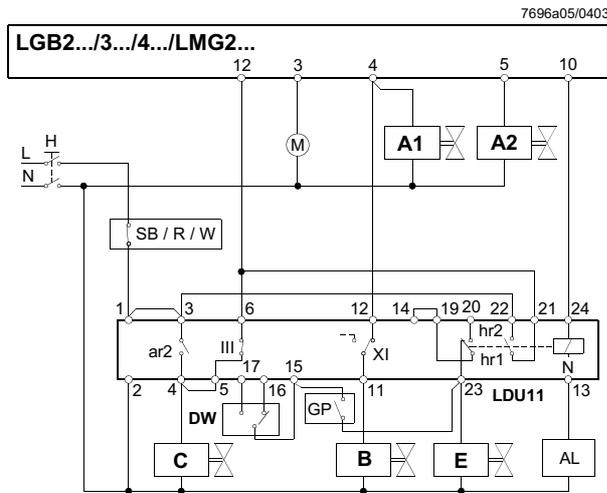
Тест проверки клапана следует тотчас после управляемого отключения
