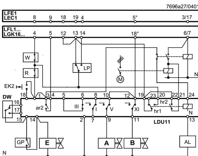
Тест проверки клапана с 2 реле давления
