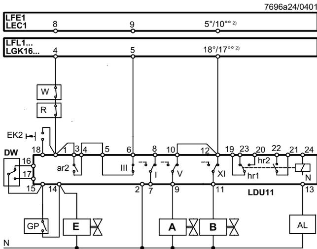
Тест проверки клапана в течение времени предподдувки (мин. 60 с)
