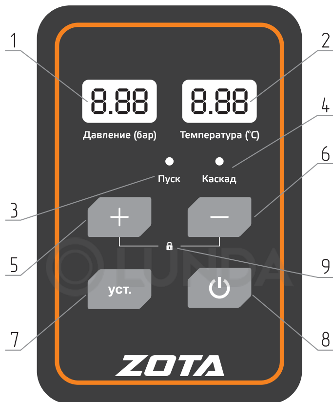
Рис.3 Дисплей панели управления насосной станции ZOTA LaScala
