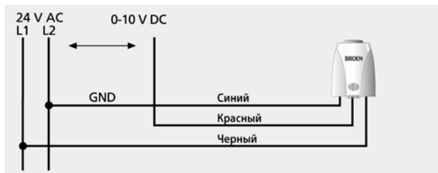
Рис.51. Схема подключения привода
