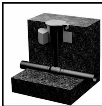
Подземный кран, установка под ковер
