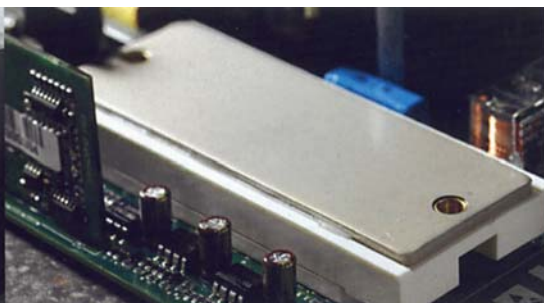
Встроенная тепловая защита в IGBT модулях
