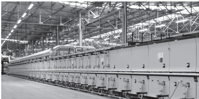
Керамическая промышленность: печь с роликовым подом
