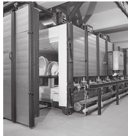
Печь с выкатным подом в керамической промышленности
