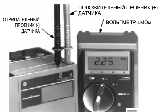
Рис. 22. Измерение сигнала пламени.
