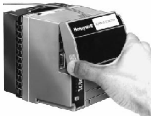
Рис. 11. Монтаж удлинителя кабеля.
