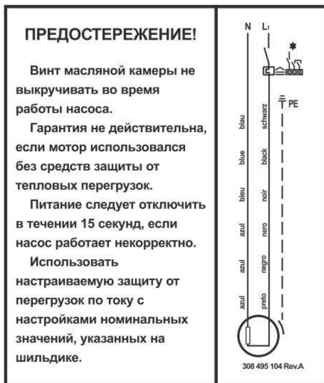
Рис.4 Однофазная схема подключения (нанесена на корпус электродвигателя)
