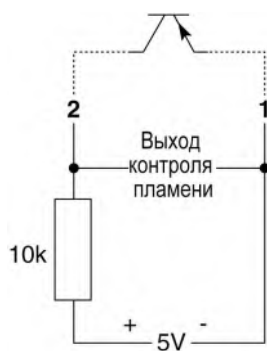
Рис. 56. Подключение выхода к оптрону
