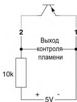
Рис. 19. Подключение выхода к оптрону
