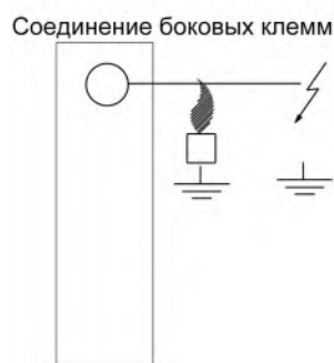
Рис. 31. Вариант соединения боковых клемм в случае искровых разрядов на землю
