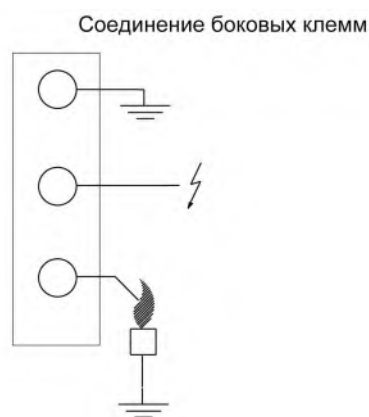
Рис. 34. Вариант соединения боковых клемм в случае искровых разрядов на землю
